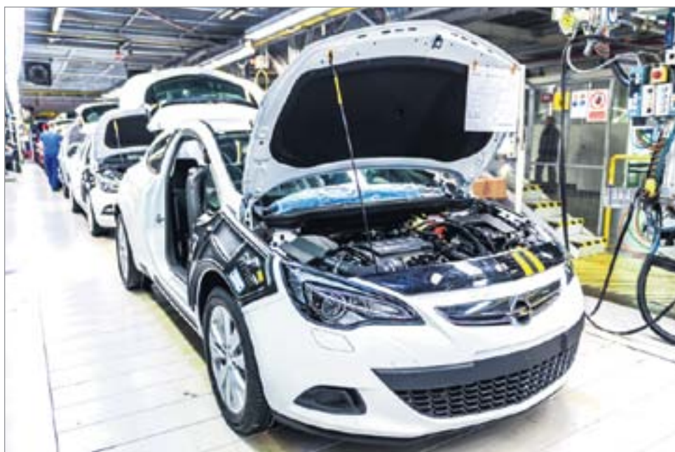
„Ożenek” czyli połączenie zawieszania i silnika z nadwoziem
